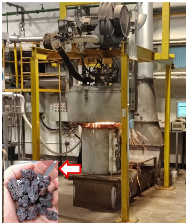
利用燒結錒進行配料計算目標所需高鹽基度燒結礦製備
