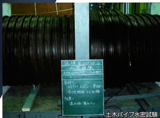
主木パイプ水密試験
