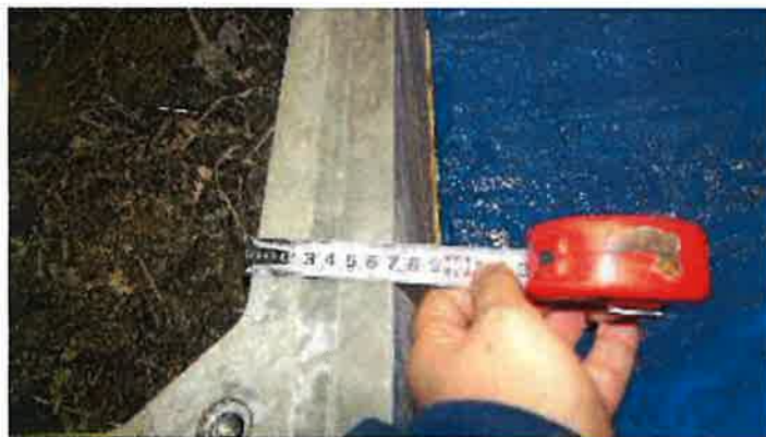
【カナフレックス核シェルターボックスの厚み測定】
